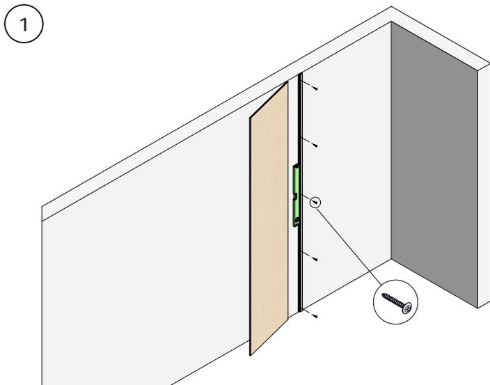
1. Atornille nuestro perfil SKARV de aluminio. Coloque el perfil en posición vertical con un nivel de burbuja.
