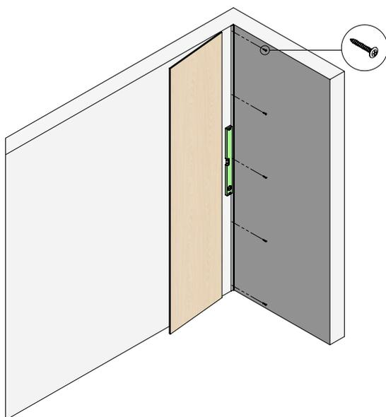
2. Cuando realice el montaje entre dos paredes existentes, comience atornillando nuestro perfil START. Coloque el perfil en posición vertical con un nivel de burbuja. Atorníllelo en su posición a 50 mm de los bordes superior e inferior, espaciados uniformemente.
