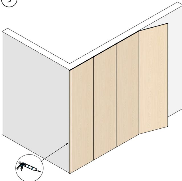
3. Aplique nuestro adhesivo de montaje al listón terminal. Introdúzcalo en nuestro perfil SKARV. Utilice cinta adhesiva para inmovilizar nuestro panel mural hasta que el adhesivo se seque. Puede continuar el montaje de esa pared mientras se seca el adhesivo.
