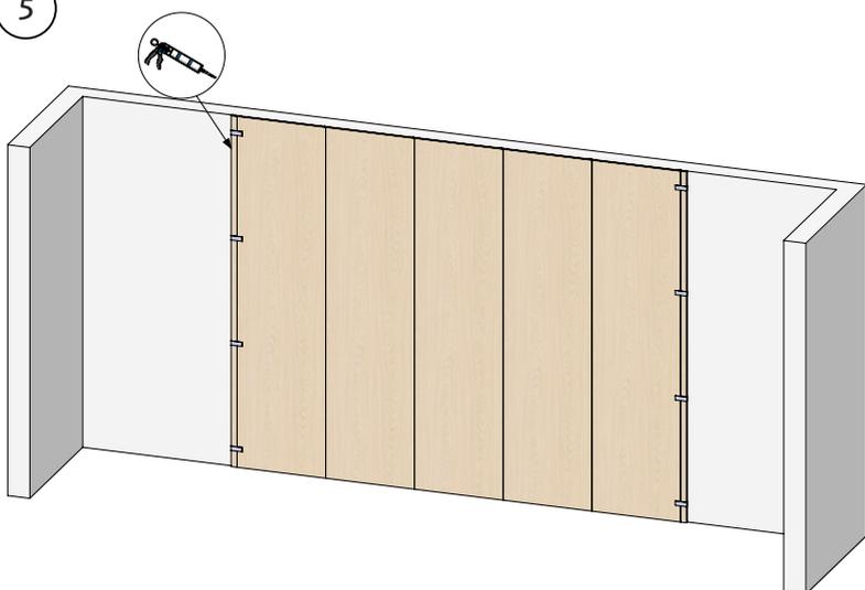
5. Aplique nuestro adhesivo de montaje al listón terminal. Introdúzcalo en nuestro perfil SKARV. Utilice cinta adhesiva para inmovilizar nuestro panel mural hasta que el adhesivo se seque.
