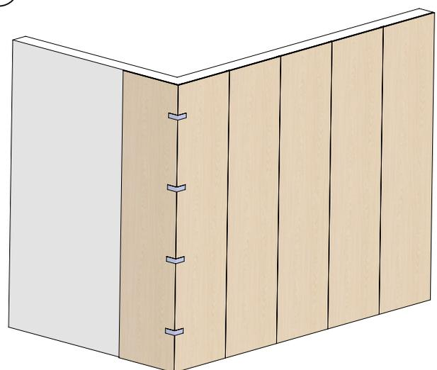
4. Una vez colocados los paneles, coloque cinta adhesiva y espere a que el adhesivo se seque.
