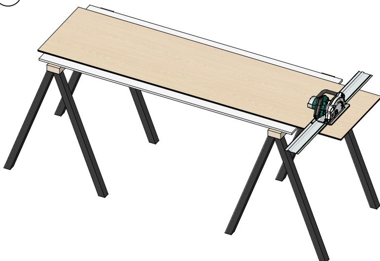
1. Mida la altura de la pared existente. Corte el panel a la altura adecuada con una sierra circular y sierra de inmersión.
