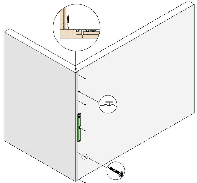
2. Cuando se coloca una esquina exterior con un listón terminal, primero se coloca un perfil SKARV. Antes de atornillar el perfil SKARV, asegúrese de sobrepasar el borde lo suficiente para cubrir tanto el panel mural como el hueco, y de que quede recto.
