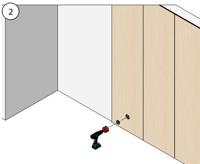
2. A continuación, instale el panel mural sobre el interruptor/enchufe/focos. Inserte el visor para encontrar el lugar donde taladrar el orificio. Taladre con una sierra perforadora.
