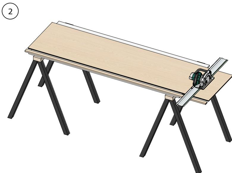
2. Mida la altura de la pared existente. Corte el panel mural y el listón terminal a la altura correcta con una sierra circular o de inmersión.
